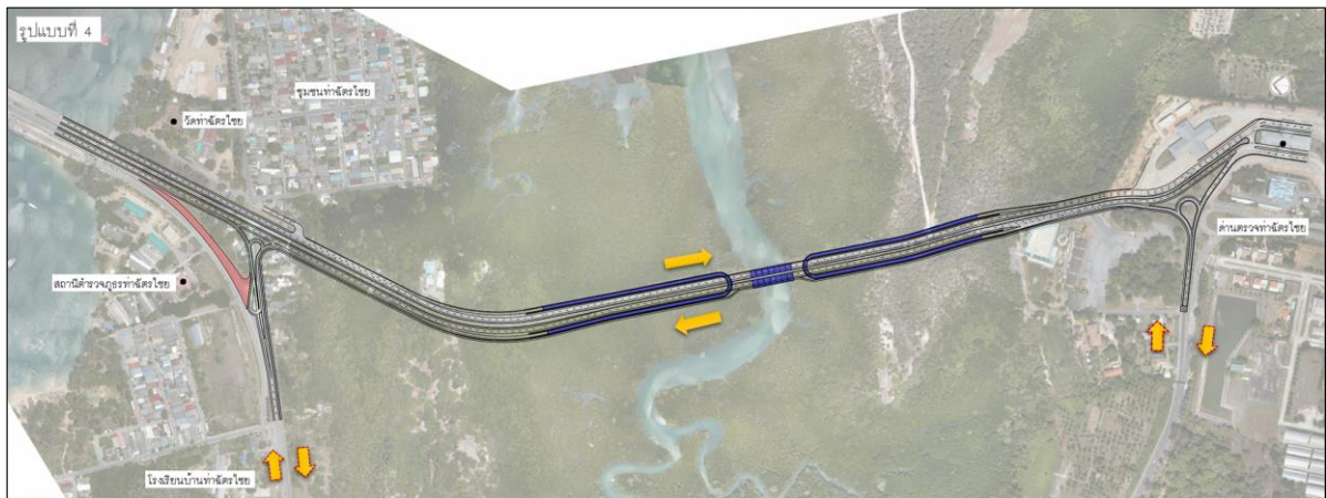
รูปที่ 6.2-4 รูปแบบที่ 4 จุดเริ่มต้นโครงการเป็นถนนระดับพื้นพร้อมสะพานกลับรถและ ถนนระดับพื้นบริเวณจุดสิ้นสุดโครงการพร้อมสะพานกลับรถ
