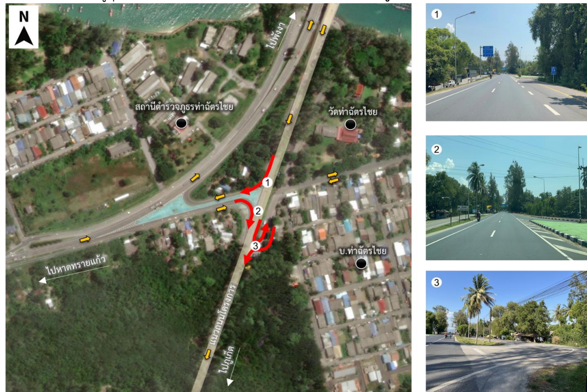
รูปที่ 5.1-1 แสดงทางแยก (Diverging) พร้อมทางร่วม (Merging) บริเวณจุดเริ่มต้นโครงการ ทางหลวงหมายเลข 402
