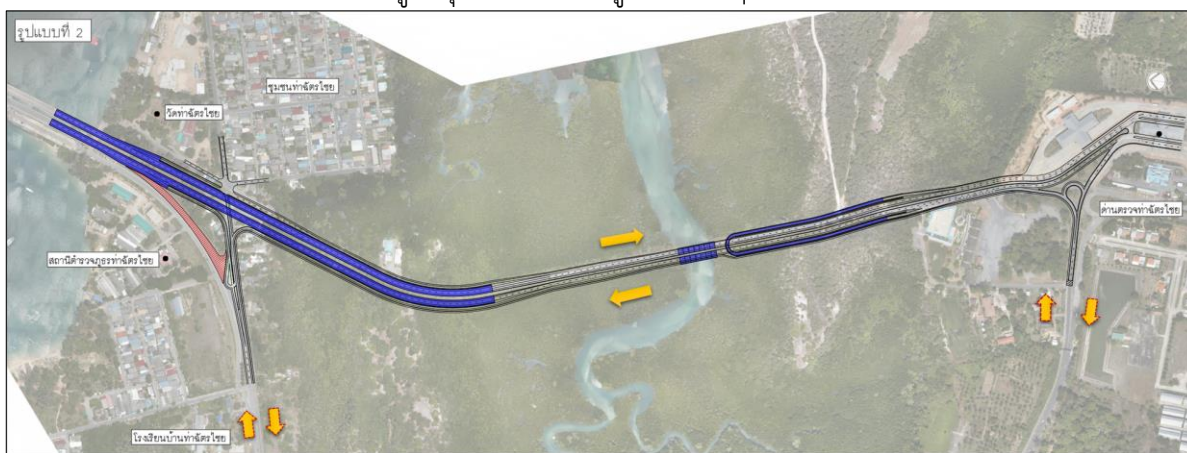
รูปที่ 6.2-2 รูปแบบที่ 2 จุดเริ่มต้นโครงการเป็นสะพานยกระดับและถนนระดับพื้นบริเวณจุดสิ้นสุดโครงการพร้อมสะพานกลับรถ
